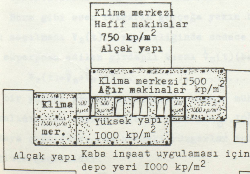
Resim 4.4.Bir teknik kat için yük planı.
