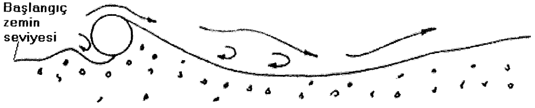
Şekil 3.9 Tünel oyulması gerçekleşmediğinde meydana gelen oyulma biçimi (Chiew, 1990)
