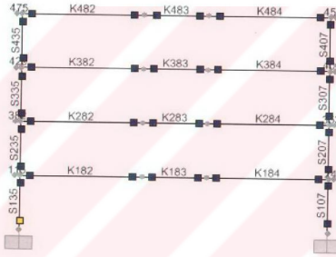
Şekil 4.46 10-10 aksı taşıyıcı sistem elemanları performans seviyeleri
