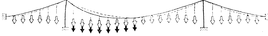
Şekil 3.15 Zemine ankrajlı asma sistem (ikinci derece stabil).
