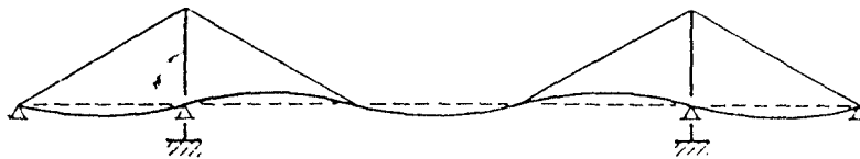
Şekil 3.179 Bir köprüde rijitlik kirişinin kablo sisteminden bağımsız salınımı.
