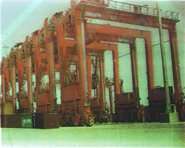
Şekil 7.6 Transteynerin depolama alanında çalışması
