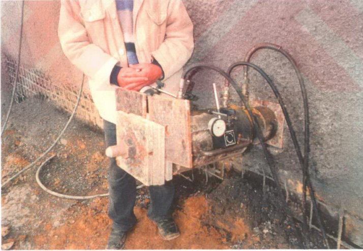
Şekil 5.17 (f) Yük hücresi takılmış ve kadranlı ölçerleri deneye hazır hale getirilmiş deney çivisi
