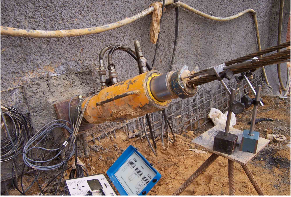
Şekil 3.8 Ankraj performans deneyi düzeneği
