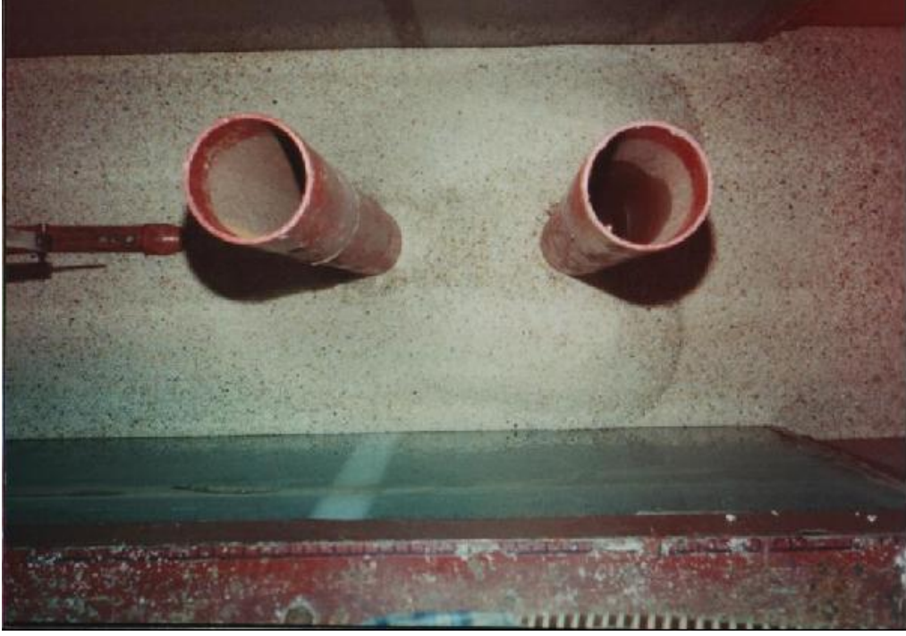
(c) D=90 mm, d_0=16 mm a/D=3 için orifis-jet erozyonu
