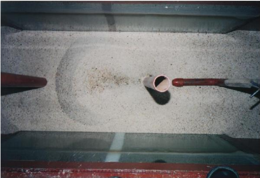
(e) D=48 mm, d_0=16 mm a/D=10 için orifis-jet erozyonu
