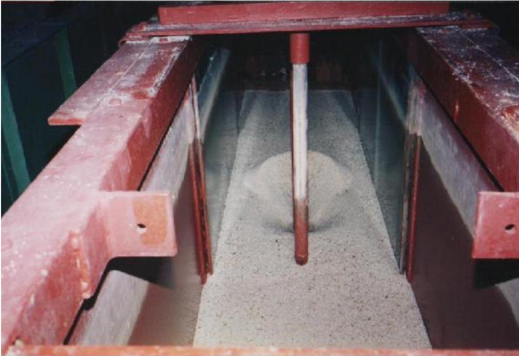
(m) D=33 mm, d_0=16 mm a/D=2 için orifis-jet erozyonu
