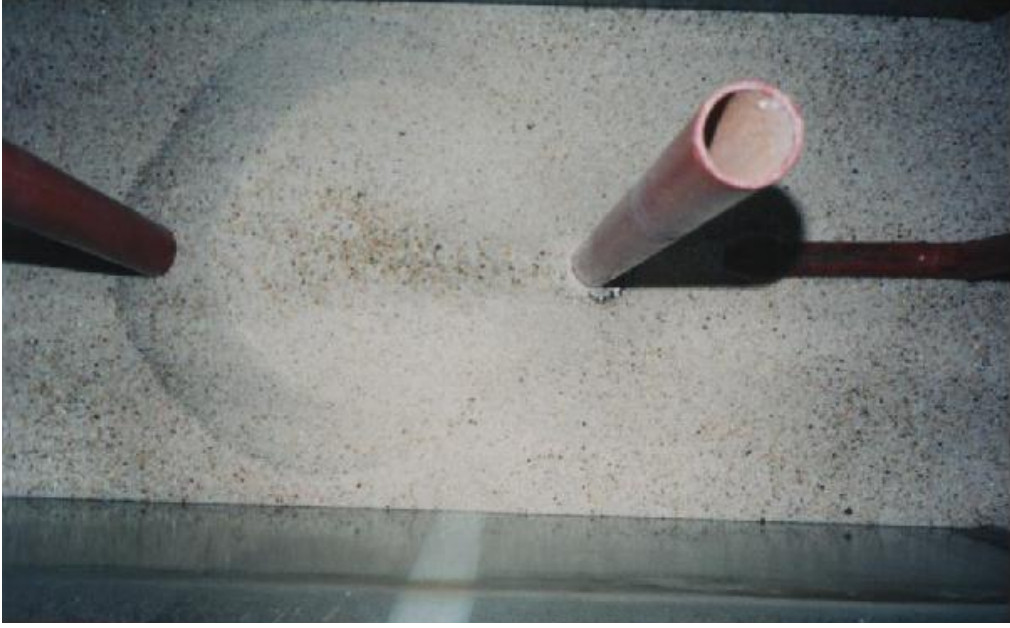
(g) D=33 mm, d_0=16 mm a/D=12 için orifis-jet erozyonu
