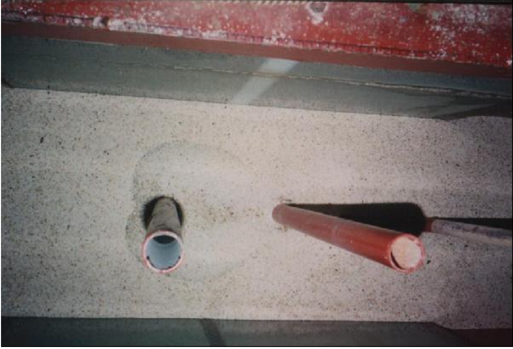
(j) D=33 mm, d_0=22 mm a/D=12 için orifis-jet erozyonu
