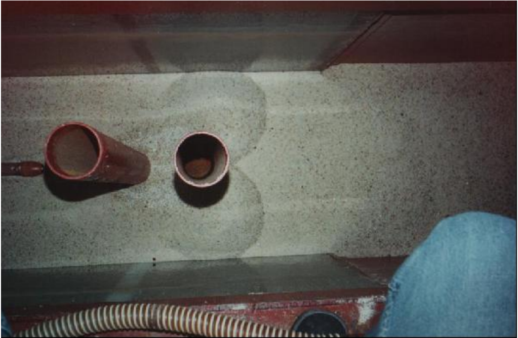
(a) D=90 mm, d_0=22 mm a/D=2 için orifis-jet erozyonu
