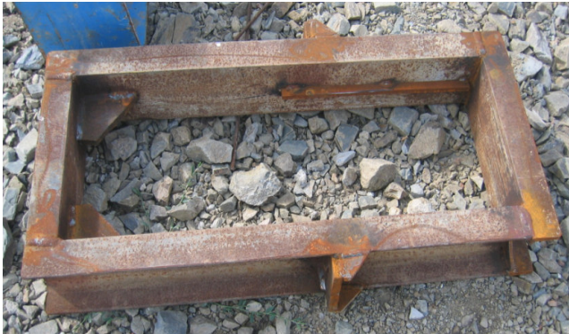
Şekil 5.7 – 1 No'lu kazığa yükün eşit olarak iletilmesini sağlayacak parçalar
