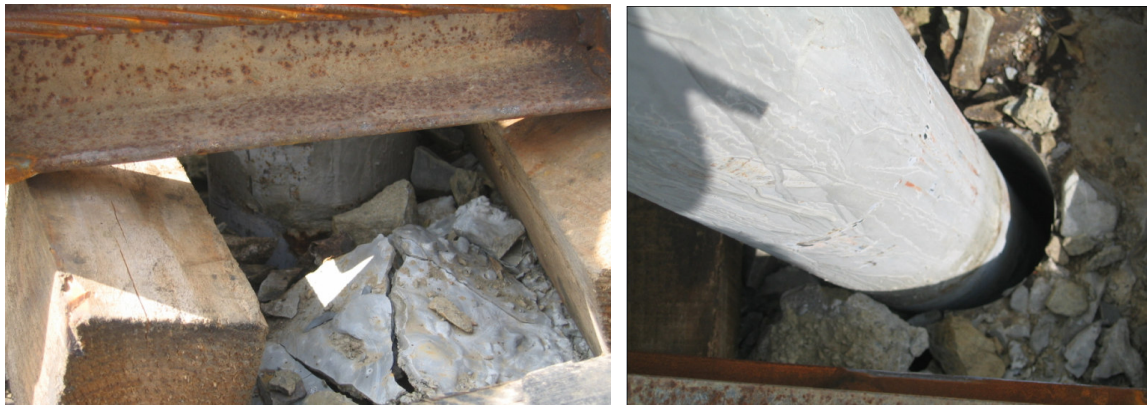
Şekil 5.10 - 50 Bar ( 39.27 kN) yükleme sonrası görülen deplasman ve griplerde meydana gelen açılma
