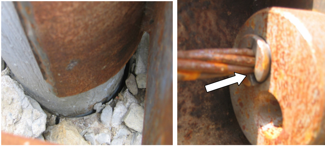
Şekil 5.10 - 50 Bar ( 39.27 kN) yükleme sonrası görülen deplasman ve griplerde meydana gelen açılma
