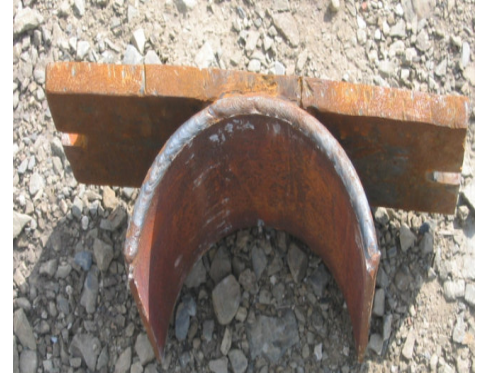
Şekil 5.7 – 1 No'lu kazığa yükün eşit olarak iletilmesini sağlayacak parçalar
