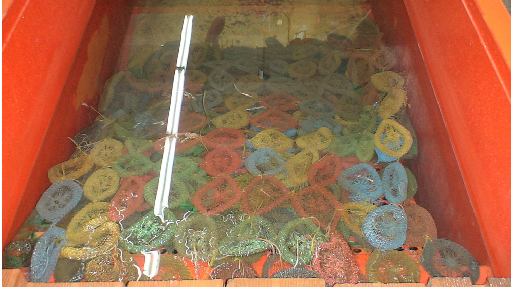
Şekil 4.5 Dalga üreticinin arkasındaki dalga sönümlendiricileri
