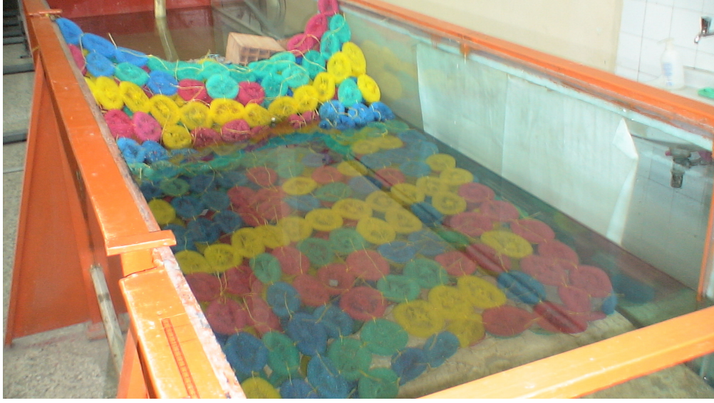
Şekil 4.4 Şev üzerindeki dalga sönümlendiricileri
