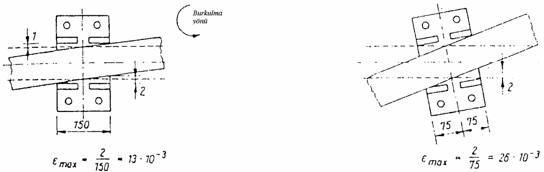
Şekil 4.4 Rayın sela üzerinde dönme açısı (Führer, 1979).
