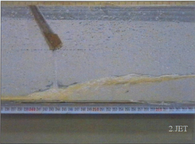
Şekil 3.7 Fr_1=3.43 , jet açısı 60^\circ için hidrolik sıçramalar
