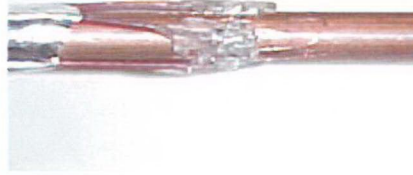
Şekil 3.4 4 adet termoelemanın bakır boru etrafına bağlantısı
