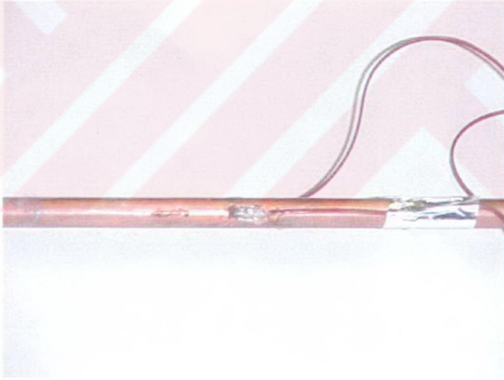
Şekil 3.3 Üzeri silikon ile kaplanmış termoeleman bağlantısı
