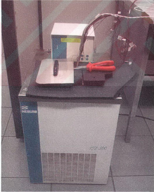
Şekil 3.11 Kalibrasyon su banyosu ve hassas termometre probunun yerleştirilmiş şekli
