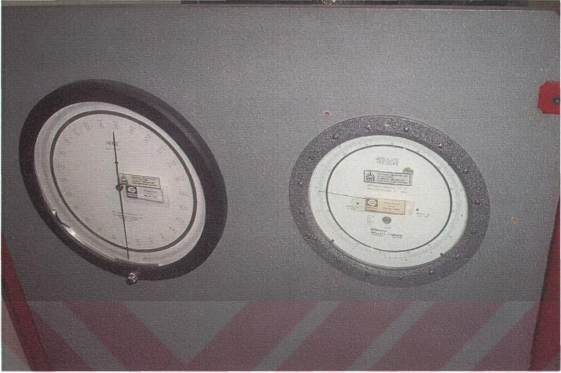
Şekil 3.14 Basınç Transduserleri kalibrasyonunda kullanılan hassas manometre
