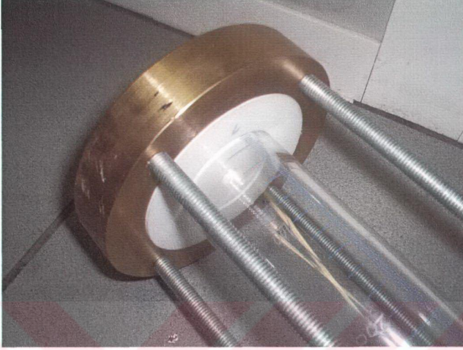
Şekil 3.7 Ölçekli kap flanşının içten görünüşü
