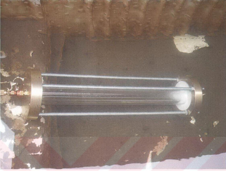
Şekil 3.18 Ölçekli kapları su içerisinde kaçak kontrolünün yapılması
