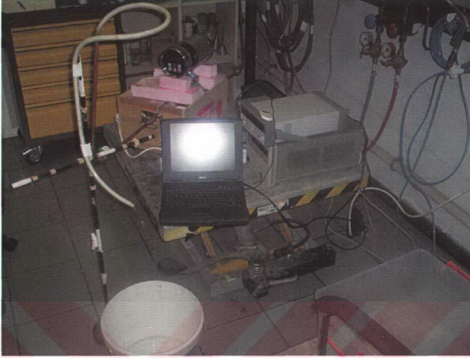
Şekil 3.16 Soğutkan debimetresi kalibrasyonu için kullanılan düzenek
